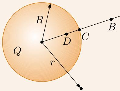
Comecemos pelos pontos no exterior da esfera, isto é,  $r > R$ , tomando o potencial como zero em  $r = \infty$ . Nos capítulos anteriores, encontramos que a intensidade do campo elétrico no exterior de uma esfera uniformemente carregada de raio  $R$  é
