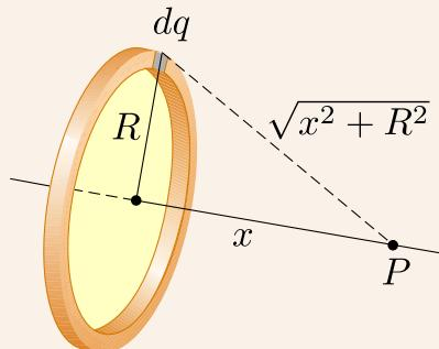
Consideremos, como na figura, que o aro está orientado tal que seu plano é perpendicular ao eixo  $x$  e seu centro está na origem. Para analisar o problema, consideraremos o ponto  $P$  estando a uma distância  $x$  do centro do aro, conforme figura. O elemento de carga  $dq$  está a uma distância  $\sqrt{x^2 + R^2}$  do ponto  $P$ . Assim, podemos expressar  $V$  como
