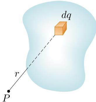
Se a distribuição de carga é conhecida, podemos considerar o potencial devido a um pequeno elemento de carga  $dq$ , tratando esse elemento como uma carga puntiforme. O potencial eletrostático  $dV$  em algum ponto  $P$  devido ao elemento de carga  $dq$  é
