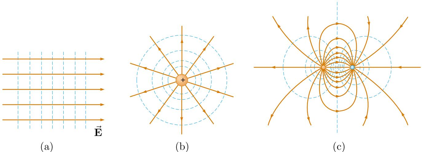
Na figura acima vemos equipotenciais (linhas tracejadas) e linhas de campo (linhas cheias) para (a) um campo elétrico uniforme produzido por um plano infinito de carga, (b) uma carga puntiforme, e (c) um dipolo elétrico. E em todos os casos, *o campo elétrico é sempre perpendicular às superfícies equipotenciais e tem sentido que aponta na direção do potencial decrescente*.
