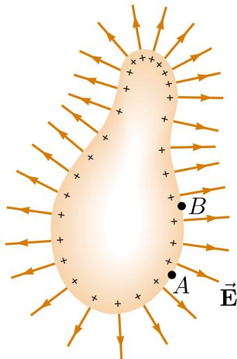
Usando um caminho ao longo da superfície que ligue os dois pontos, vemos que o campo  $\vec{E}$  é sempre perpendicular ao deslocamento  $d\vec{l}$ , de modo que  $\vec{E} \cdot d\vec{l} = 0$ . Usando esse resultado, vemos que
